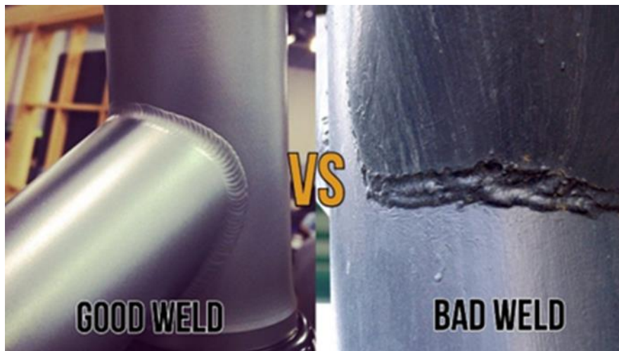
Fig. 3.2.32: Diferența dintre sudura bună și neacceptată, exemplu 1.
