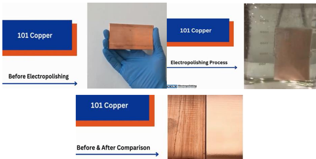
Fig. 2.1.37 Detectarea defectelor de suprafață înainte și după lustruirea electrolică pentru cupru 101 [2.1.16]
