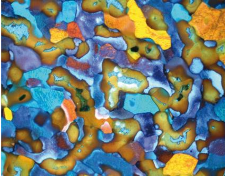
Figura 2.2.67. Diferențele de concentrație într-un fir de bronz (K) (sursa: Leica Microsystems)
