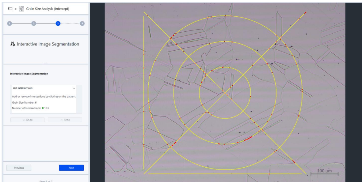
Fig. 2.4.12– Detalii de măsurare a granulometriei prin metoda de interceptare pe un oțel inoxidabil super austenitic (Tip AISI 310LMO), conform UNI EN ISO 643. Figura prezintă o eroare de măsurare a analizei imaginii din cauza incapacității de a distingeți granițele de cereale de gemenii de cereale. Sursa: IIS Laboratory.
