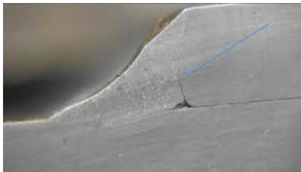
Fig. 3.2.29: Lipsa de fuziune.
