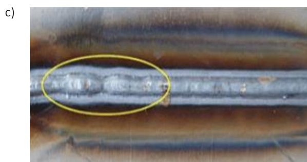
Fig 1.3.22: Imperfecțiuni constatate în timpul inspecțiilor vizuale: stropi localizați (a); zona neuniform afectată termic (b); suraînălțări locale și cratera la nivelul sudurii (c) [1.3.32]
