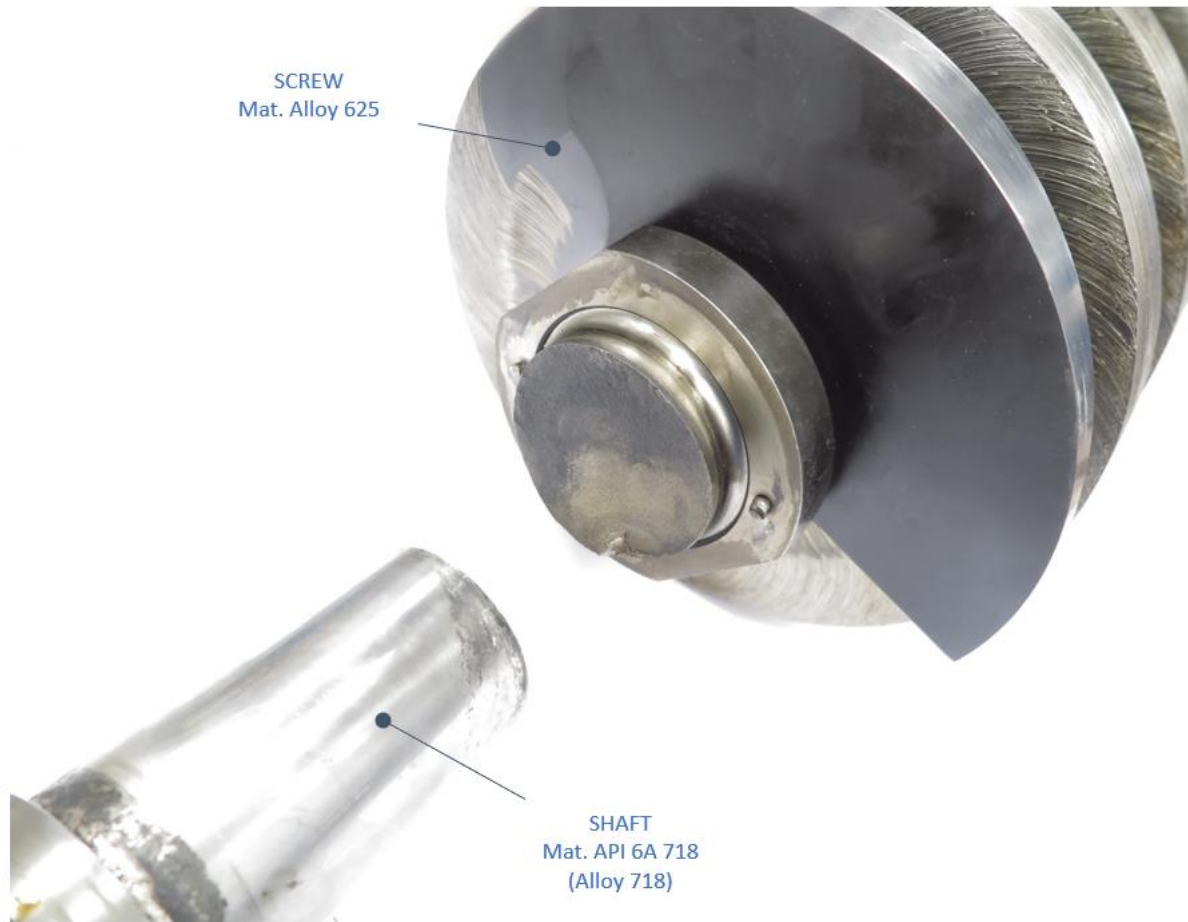
Fig. 2.6.5 – Exemplu de arbore din aliaj de nichel fracturat de fenomene de oboseală. Sursă: IIS Laboratory.
