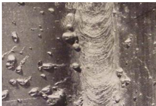
Fig. 3.2.10. Caracteristicile vizuale ale stropilor. Sursă: M.S. Rogers, Welding Inspection Defects/Repairs Course Reference WIS 5, 2003.
