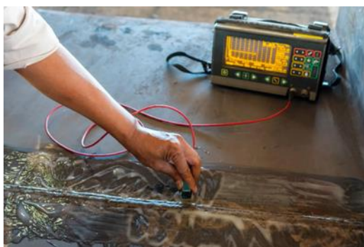
Fig. 1.3.25: Testarea cu ultrasunete a sudurii [1.3.34]
