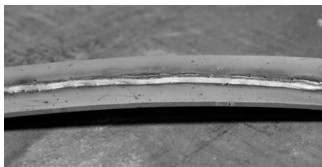
Fig. 1.3.20.2: Un exemplu de distorsiune [1.3.31]
