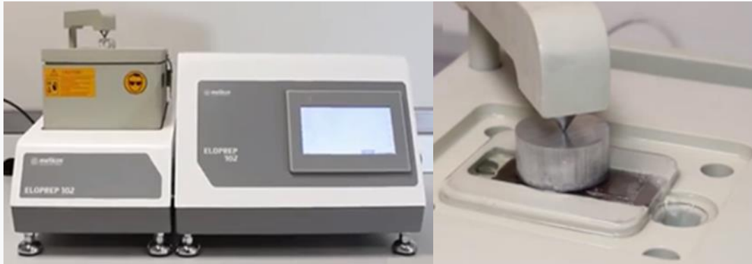
Figura 2.2.5. Echipament pentru polizor electrolitic cu celula electrolitică
