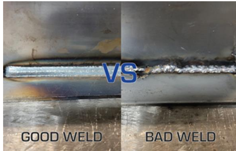
Fig. 3.2.33: Diferența dintre sudura bună și neacceptată, exemplu 2.
