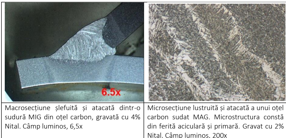
Fig. 2.1.14 Oțel carbon înainte și după atacul chimic [2.1.10]
