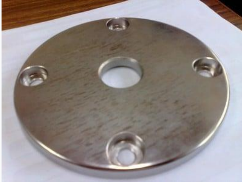
Figura 2.2.19. dungi pe SS304 prelucrat după electrolustruire (sursa: Global Spec)
