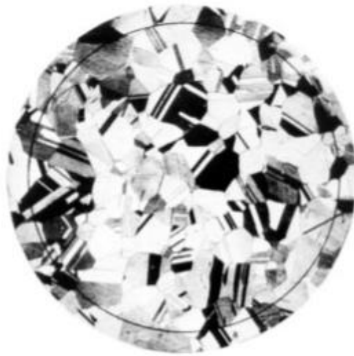
Fig. 2.3.9- exemplu de grăunți gemeni (gravuri de contrast) din placa III - dimensiunea grăuntelui 4 la 75X - imagine preluată din ASTM E112. Sursa: [2.3.6] ASTM E112 - Metode standard de testare pentru determinarea dimensiunii medii a grăunților.
