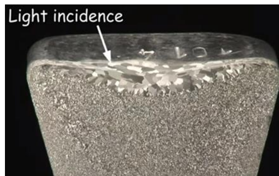
Fig. 2.1.41 Evaluarea limitelor grăunților după lustruirea chimică pentru oțel inoxidabil
