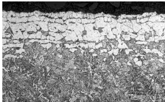
Figure 3.6.3. Suprafața decarburată a oțelului C-Mn
