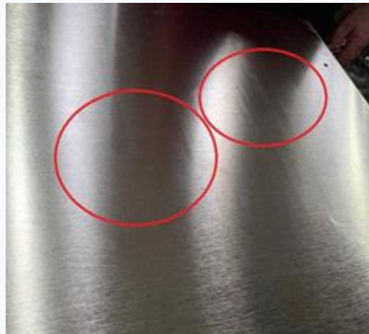
Figura 2.2.14. Lustruire neuniformă pe tablă de oțel inoxidabil (sursa: AzOm)
